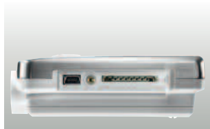
Разъем для подключения Мини-USB кабеля и SD-карты
