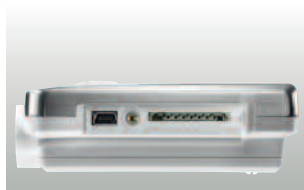
Разъем для подключения Мини-USB кабеля и SD-карты
