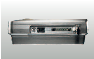
Разъем для подключения Мини-USB кабеля или SD-карты
