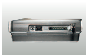
Разъем для подключения Мини-USB кабеля и SD-карты
