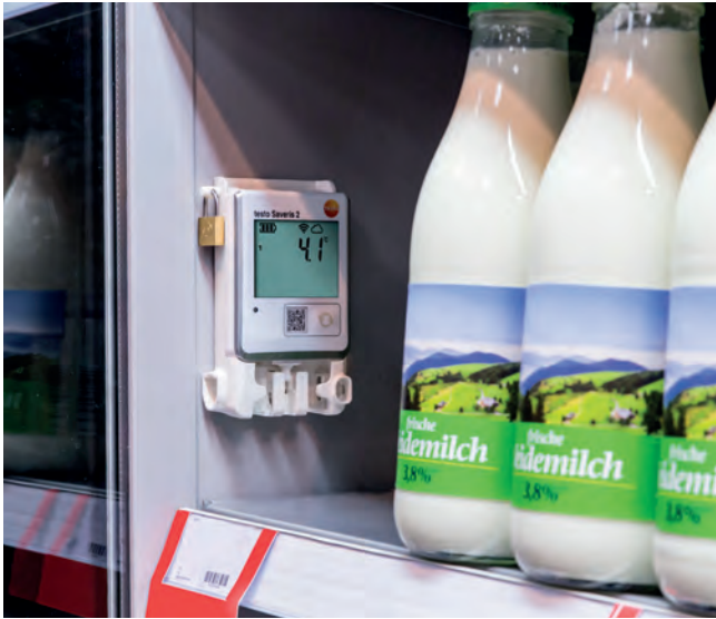
WiFi-логгеры данных передают измеренные значения из охлаждаемой зоны напрямую в Облако Testo Cloud, где они хранятся.
