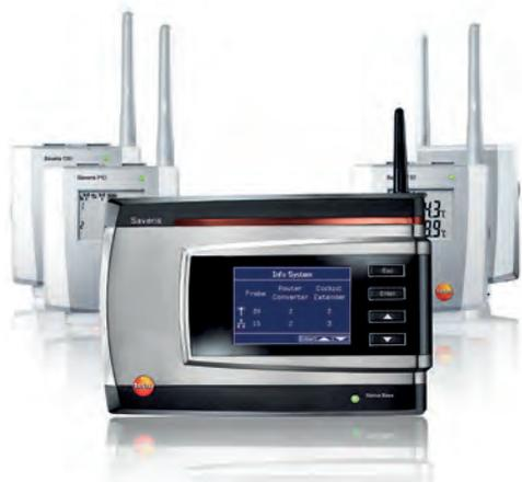
Система мониторинга данных измерений testo Saveris.
