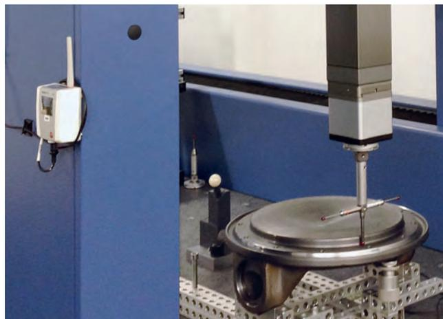
Мониторинг условий окружающей среды в измерительной лаборатории с помощью логгера данных testo Saveris.
